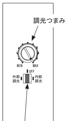
外部調光と内部調光の切換えと入力電源OFFのスイッチです。
