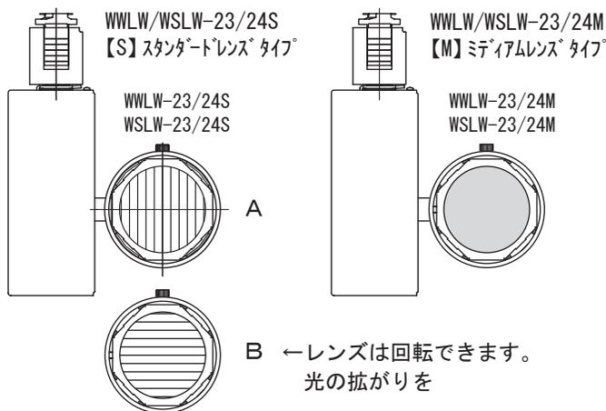
A：横方向に / B：縦方向に調整できます。
